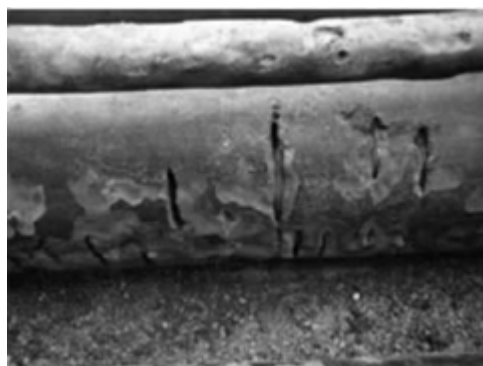
图 2.3 被白蚁侵蚀的电缆外护套
